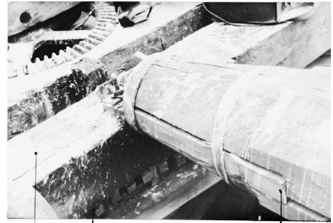
Trinkelė, su kuria pritvirtinta ašis sparninio veleno laibgalys Ubraminė reguliuojama ašoline sija kepurėje
